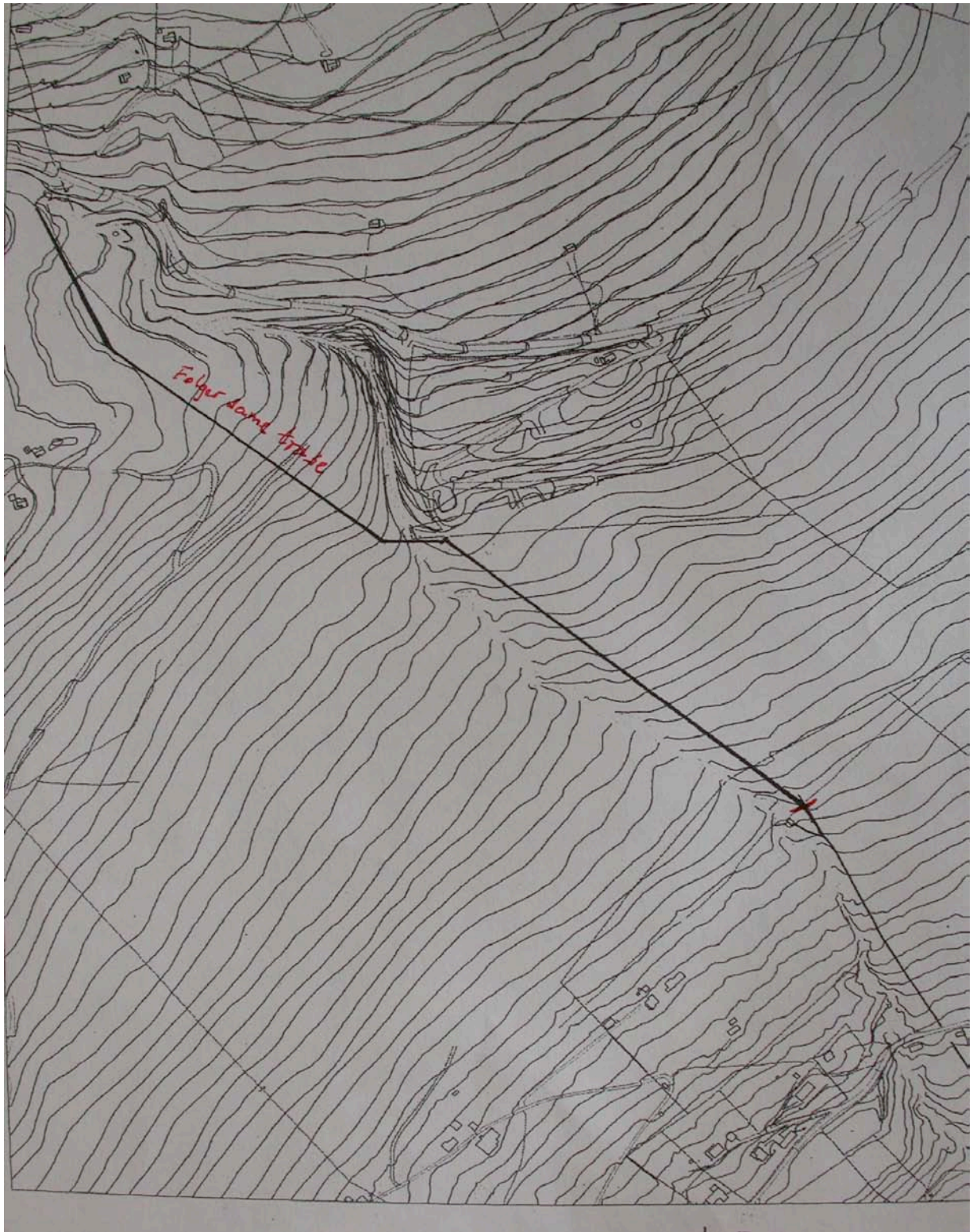
Figur 2. Skisse over rørtrasé fra inntaksdam og omlag ned til gammel inntaksdam. Traseen kryssar elva rett ned for søppelplassen.
