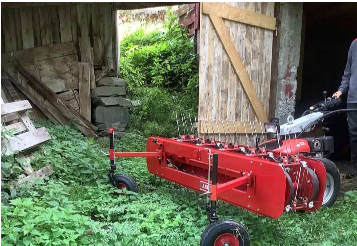
Figur 18. Bildet viser den nyinnkjøpte slåmaskina til Ole Løkra – her påmontert venderive. Det er også mer ekstrautstyr å få til denne som Løkra vil søke om midler til å kjøpe inn, da dette vil lette skjøtselen betydelig. Se evalueringsskjemaet i vedlegg 3. Foto: Kamilla Svingen, Bioreg AS © 14.08.2019.
