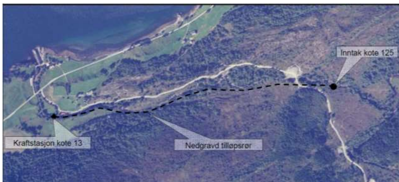
Figur 3. Flyfotoet viser dei viktigaste naturinngrepa i det planlagde prosjektet i form av inntak, røyrgate og kraftstasjon. Nyare målingar viser at stasjonen vert liggjande på kote 11, ikkje kote 13 slik denne skissa viser. Kartet er henta frå konsesjonssøknaden.
