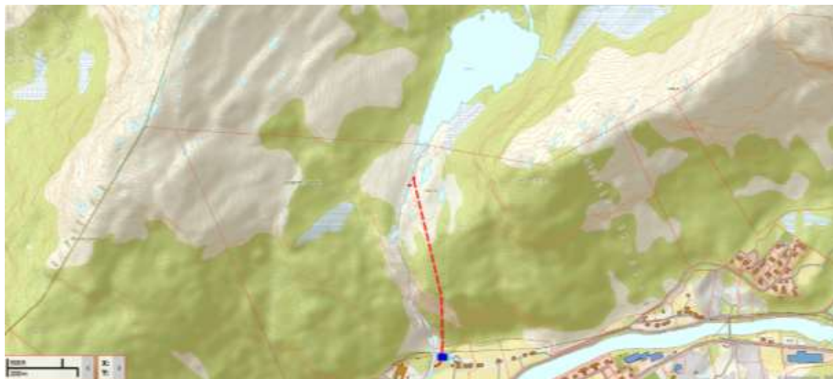
Figur 3. Kartutsnittet viser i grove trekk dei viktigaste naturinngrepa i form av dam, inntak, tunnel og kraftstasjon. Også avlaupskanalen og tilkomstvegen er innteikna her. Kraftstasjonen er tenkt plassert om lag rett nedstraums Kvernhusfossen som også er rekna som absolutt vandringshinder for anadrom fisk i elva. Kartet er henta frå GisLink.
