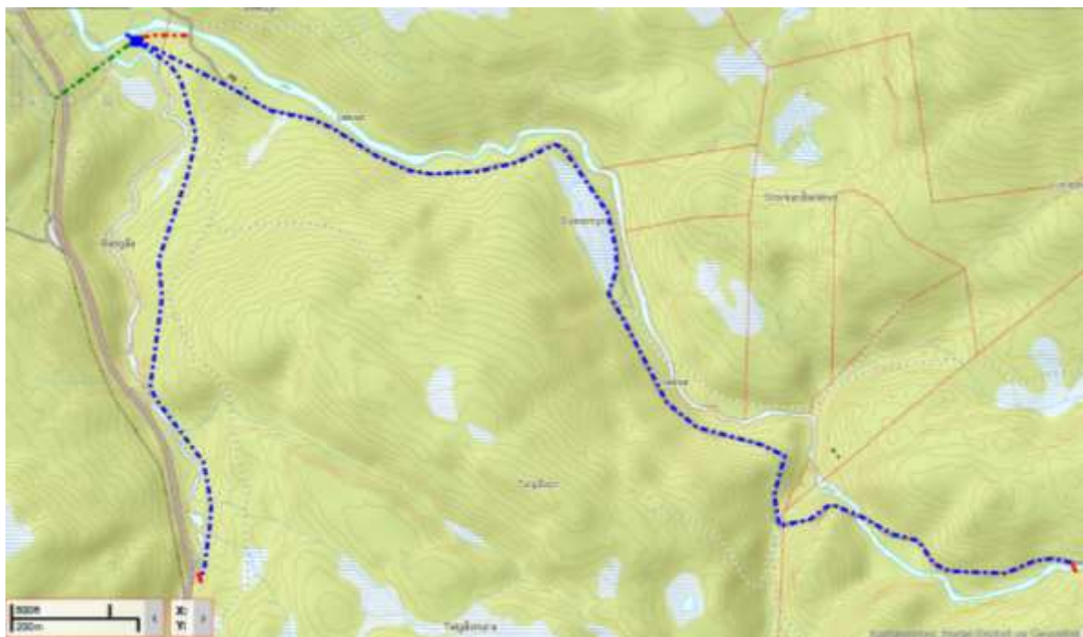
Figur 3. Kartutsnittet viser de viktigste naturinngrepene for det planlagte prosjektet i form av inntak, rørgate og kraftstasjon. Også prosjektet i Leksa er tegnet inn her i og med at disse har felles kraftstasjon. Grunnkartet er hentet fra Gislink.
