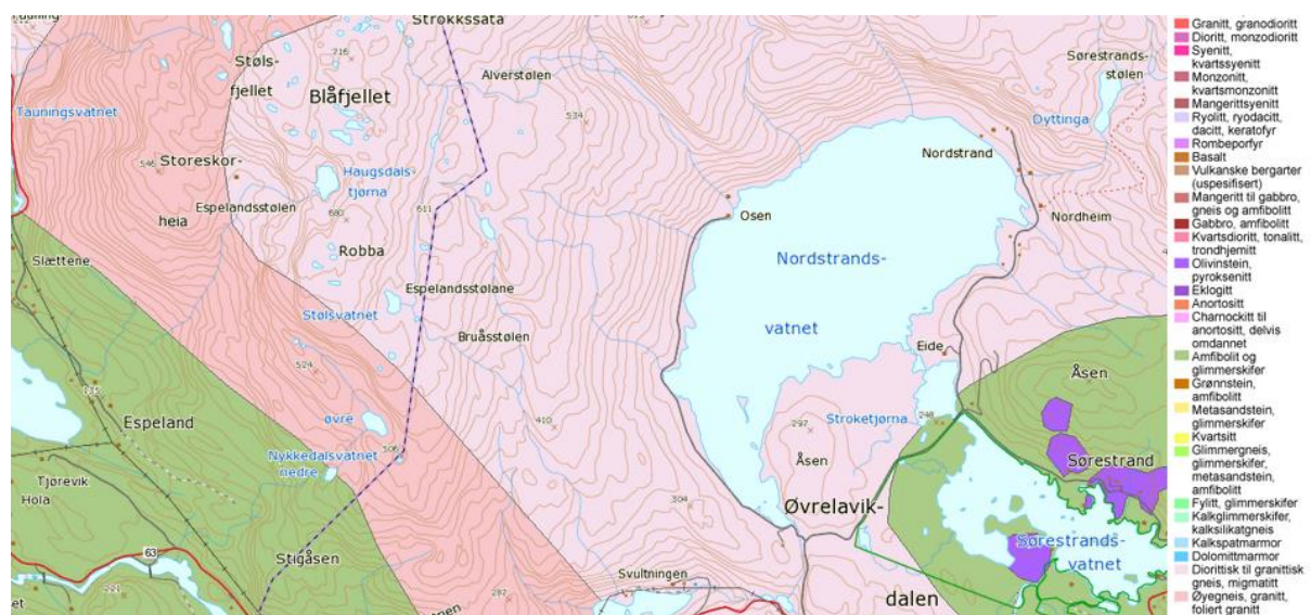
Figur 9. Kartet viser at all berggrunn innan utbyggingsområdet består av diorittisk til granittisk gneis, nokre stadar migmatittisk (Kjelde: NGU). Dette gjeld også for området der nett-tilknytninga er planlagt mellom Nordstrandsvatnet og Sjørelavikdalen. Denne bergarten gjev oftast berre grunnlag for ein fattig flora.
