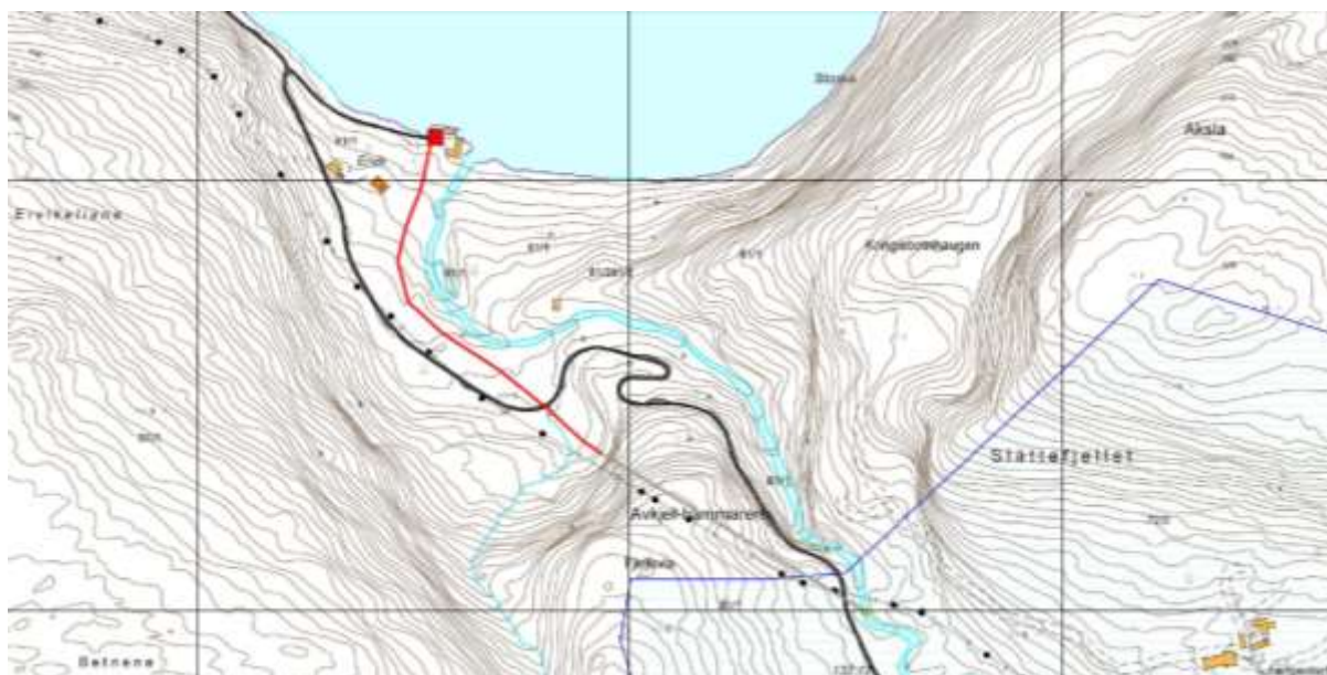
Figur 3. Kartutsnittet viser i grove trekk dei viktigaste naturinngrepa i form av inntak, tunell, røyrgate, tilkomstveg og kraftstasjon. Kartet er henta frå konsesjonssøknaden.
