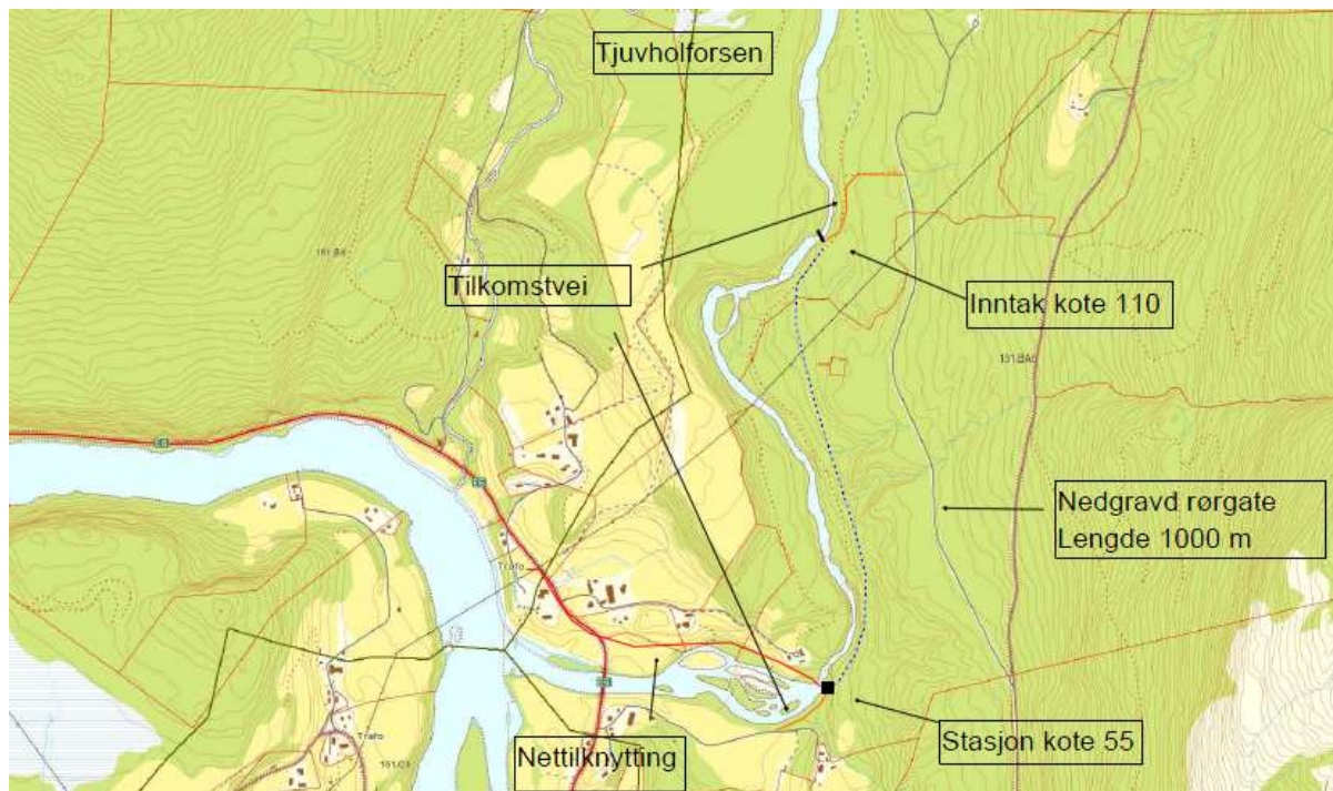
Figur 3. Kartutsnittet viser de viktigste naturinngrepene for det planlagte prosjektet i form av inntak, rørgatetrase, kraftstasjon og tilkomstveier. Kartet er hentet fra konsesjonssøknaden.
