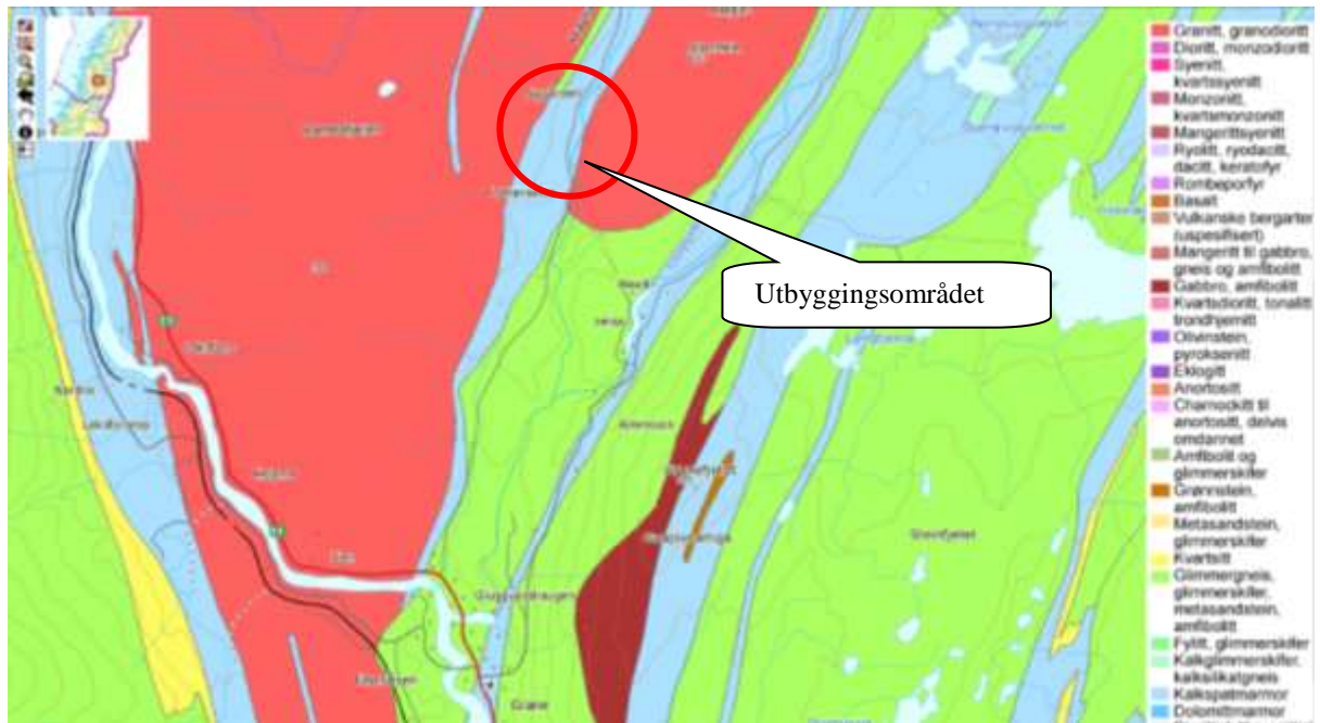
Figur 7. Utbyggingsområdet ligger innenfor den røde sirkelen. Berggrunnen innen tiltaksområdet har områder bestående av granitt i form av øygranitt og øygneis i deler av utbyggingsområdet, og marmor, vesentlig kalkspatmarmor i andre deler av området. (Kilde: NGU). Granitt og gneis er oftest harde og sure bergarter som kun gir rom for en triviell flora, mens kalkspatmarmor oftest medfører en rikere flora.
