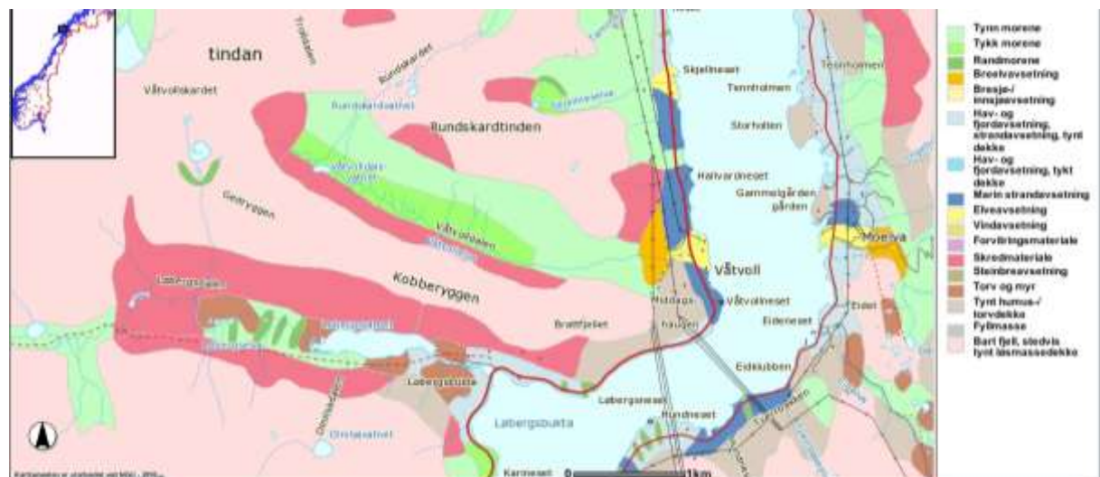
Figur 8. Innen dette utbyggingsområdet er det de fleste steder godt om lausmasser. Det gjelder så vel langs elva som langs rørtraseen. Nederst ser en at det både er innslag av breelavsetning og vanlig elveavsetning i tillegg til marin strandavsetning på begge sider av elva. (Kilde NGU).
