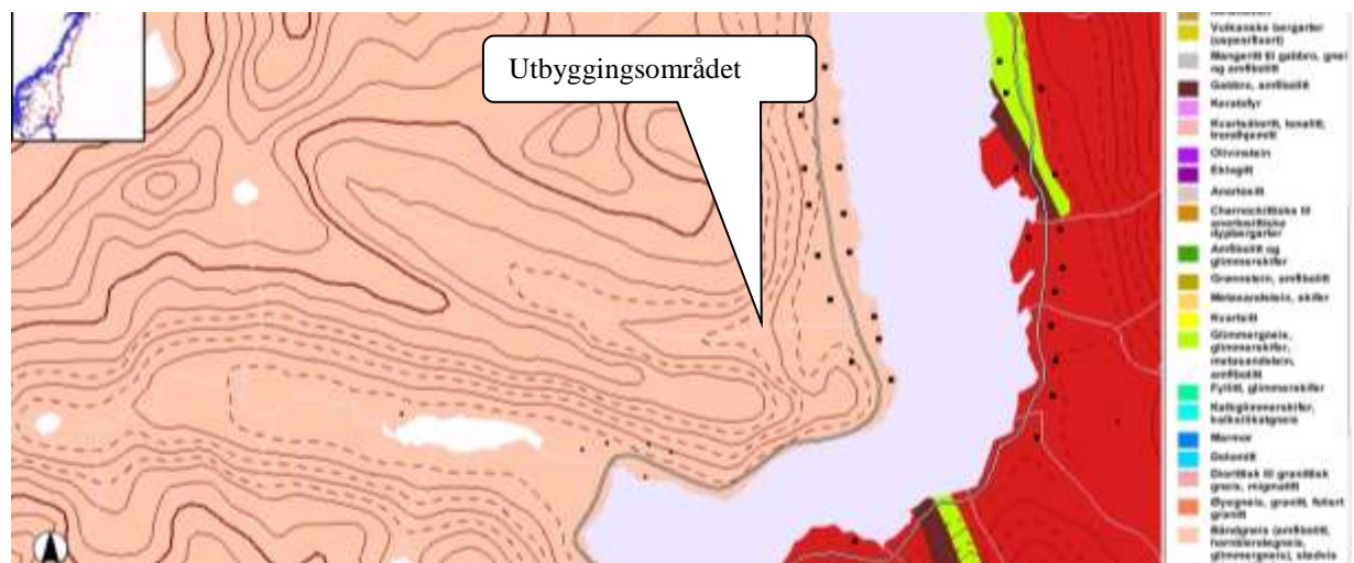
Figur 7. I berggrunnen i dette området er det mest harde gneiser, for det meste båndgneis med innslag av amfibolitt, hornblendegneis, glimmergneis, stedvis migmatittisk. (Kilde: NGU). Harde gneiser gir i regelen bare grunnlag for en fattig flora, mens de sistnevnte artene ofte kan føre til en noe rikere flora.
