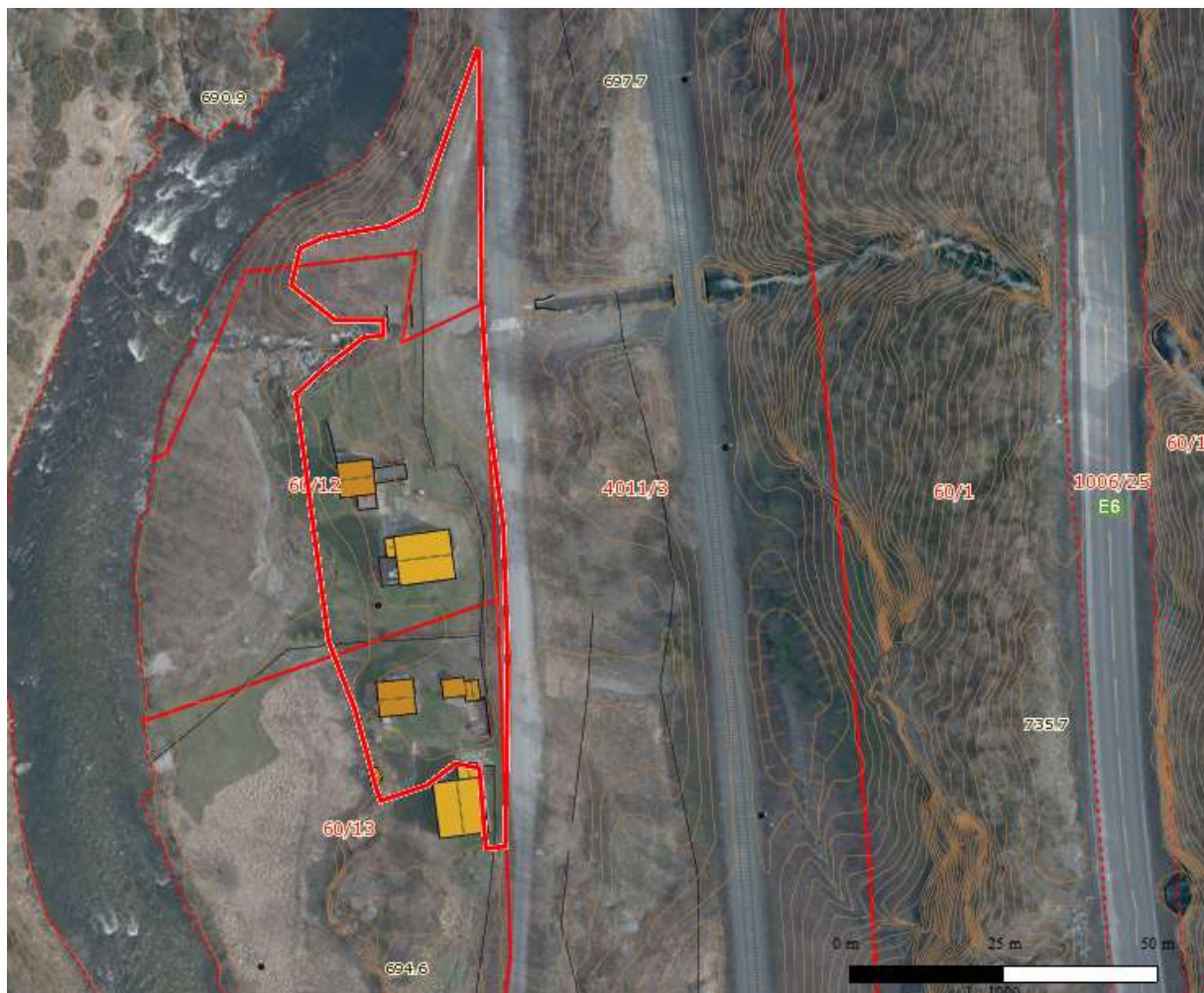
Figur 21. Flyfoto fra Gislink. Som en ser inngår tre forskjellige eiendommer i lokaliteten. Videre er det en del forskjeller mellom gjerder og grenselinjer.
