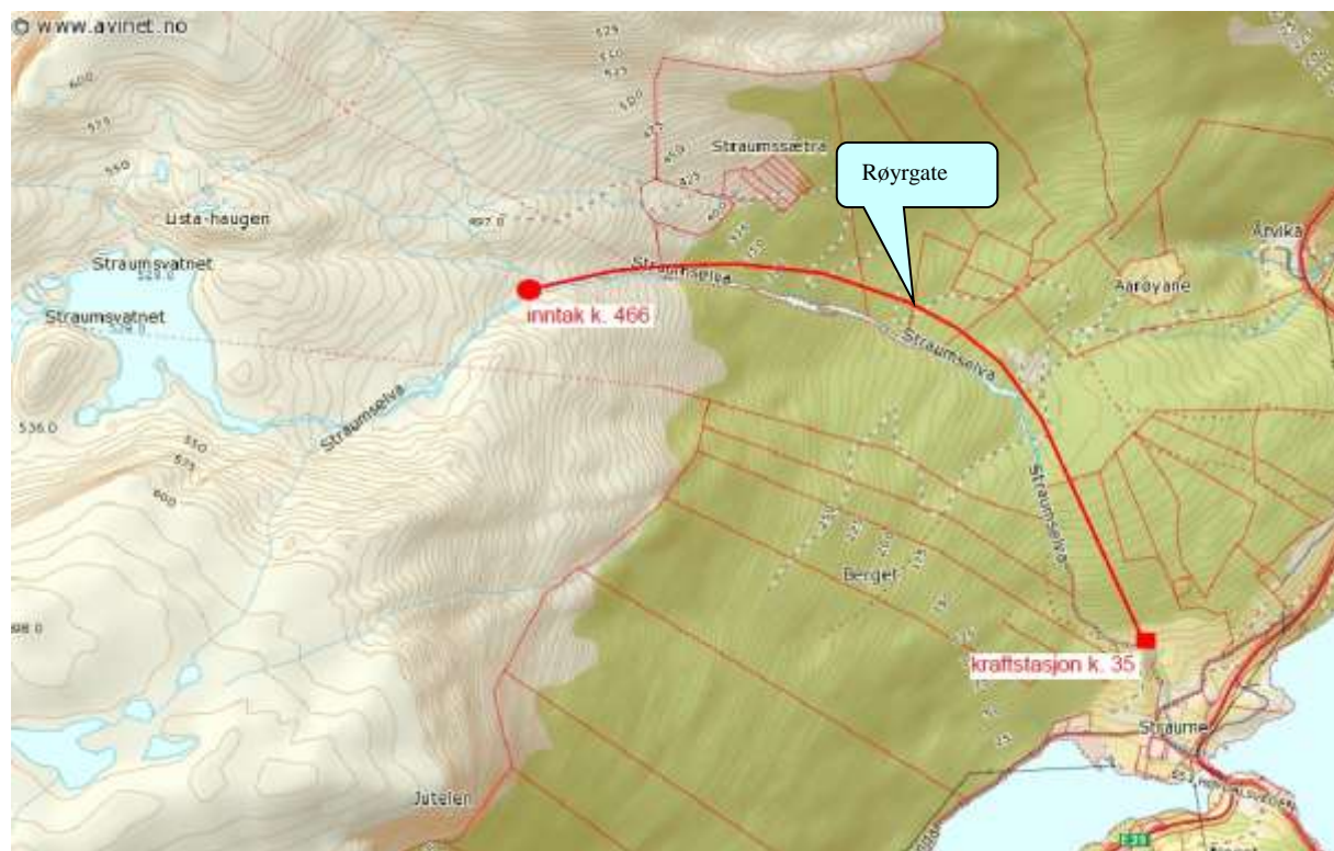
Figur 3. Kartutsnittet viser i grove trekk dei viktigaste naturinngrepa i form av inntak, rørgate og kraftstasjon. Bekkeoverføringa er ikkje kome med på denne planteikninga. Kraftstasjonen ligg om lag 200 nedstrøms ein foss (absolutt vandringshinder).
