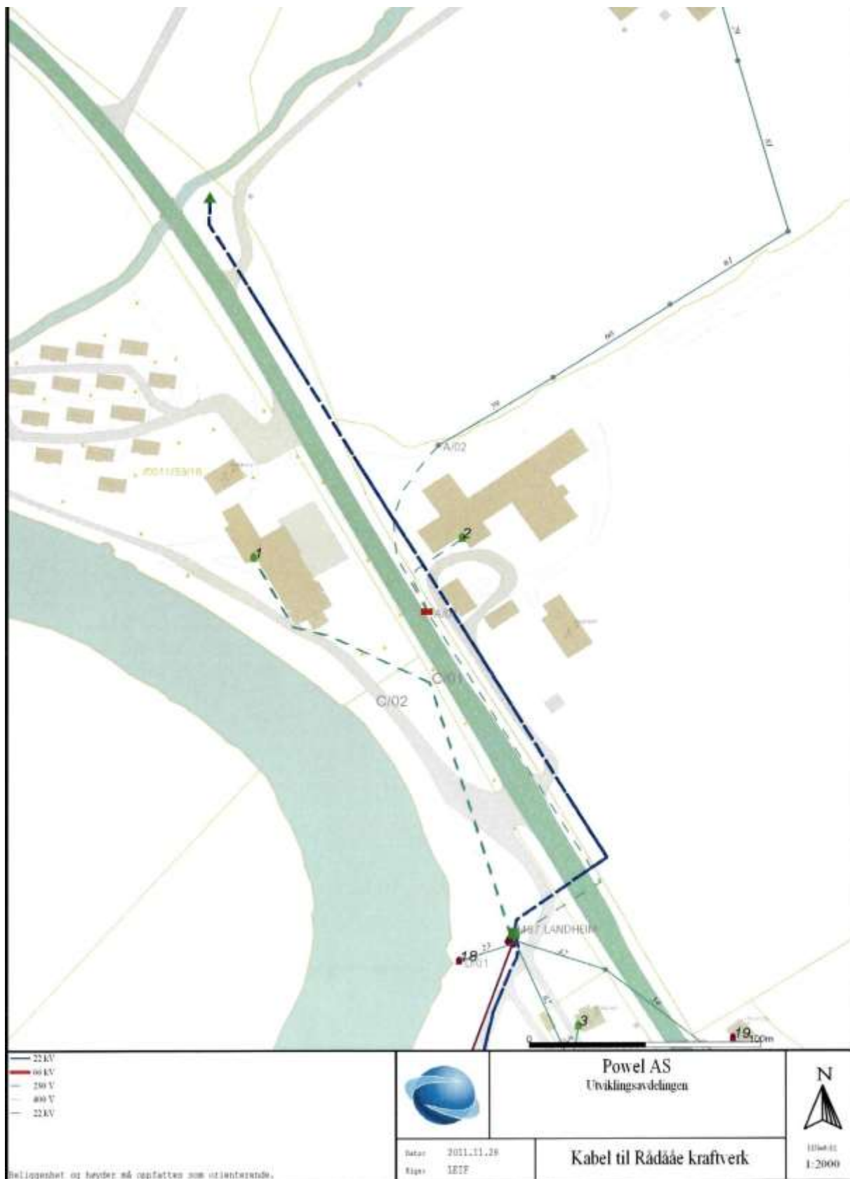
Figur 6. Kartskissen viser nettselskapets forslag til hvordan den produserte strømmen skal overføres til eksisterende nett. Traseen vil hovedsaklig komme til gå over fulldyrka mark, ev langs vei, slik at den ikke vil komme i konflikt med biologisk mangfold. Den vil krysse E6 ved nettstasjon 3487 Landheim.
