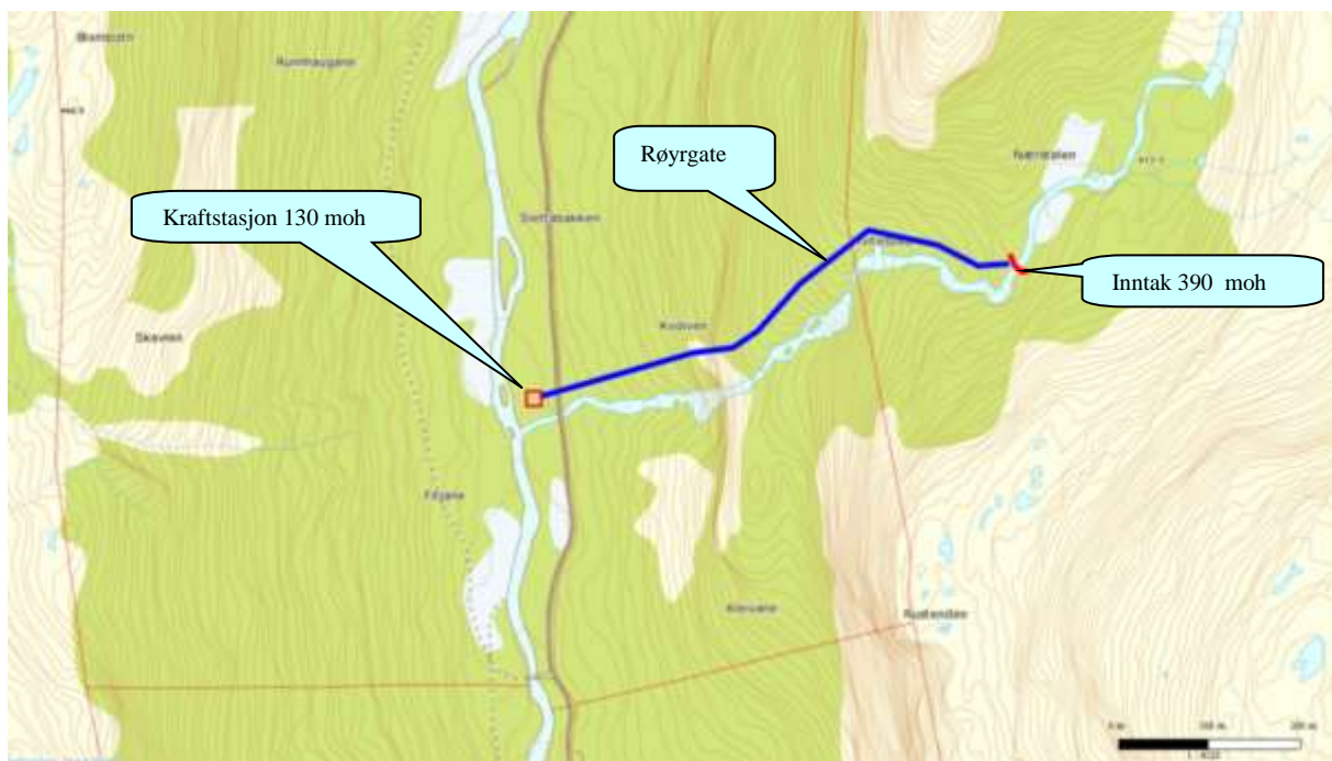
Figur 3. Kartutsnittet viser i grove trekk dei viktigaste naturinngrepa i form av inntak, røyrgate og kraftstasjon. Kraftstasjonen vert liggjande litt oppstrøms for inntaket til det planlagde Budalen kraftverk.
