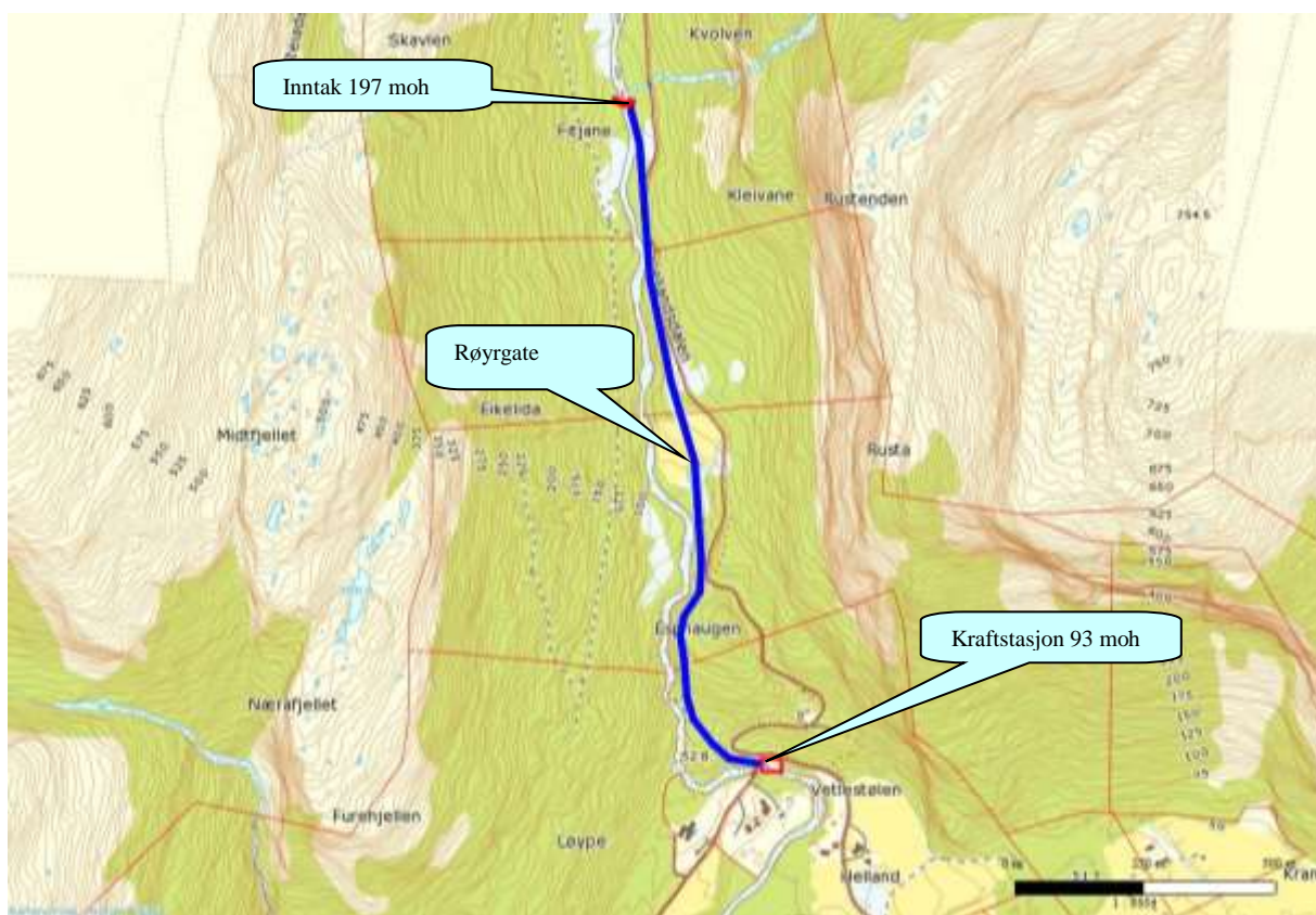
Figur 3. Kartutsnittet viser i grove trekk dei viktigaste naturinngrepa i form av inntak, røyrgate og kraftstasjon.
