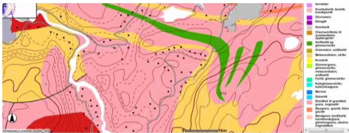
Figur 8. I fylgje berggrunnskartet, så er det mest diorittisk til granittisk gneis innan utbyggingsområdet. Eit band med kvartsitt kryssar elva i den nedre delen (den gule), medan ei band av amfibolitt og glimmerskifer (den grønne) kryssar utbyggingsområdet rett nedanfor inntaket. (Kjelde NGU).
