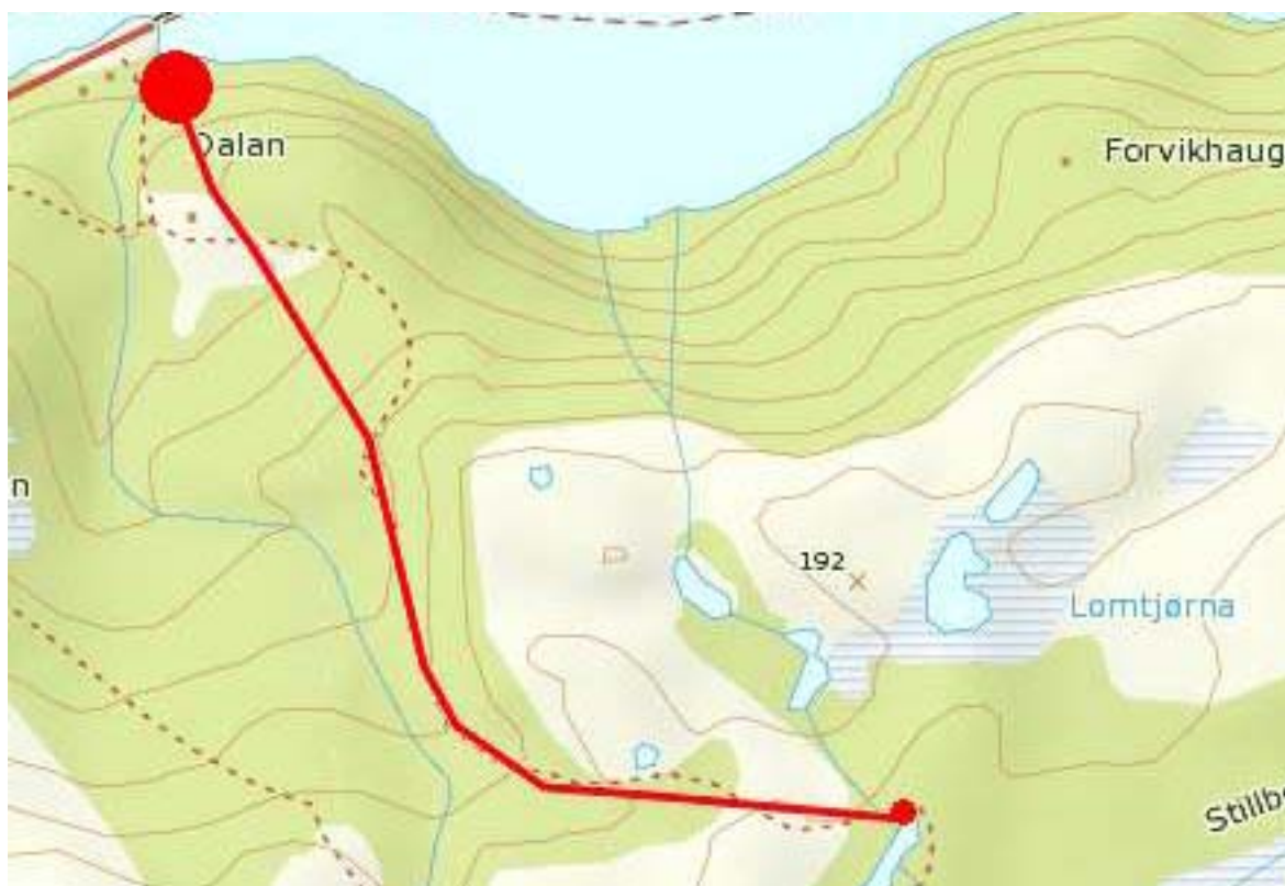
Figur 3. Kartutsnittet viser de viktigste naturinngrepene for det planlagte prosjektet i form av inntak, rørgate og kraftstasjon.
