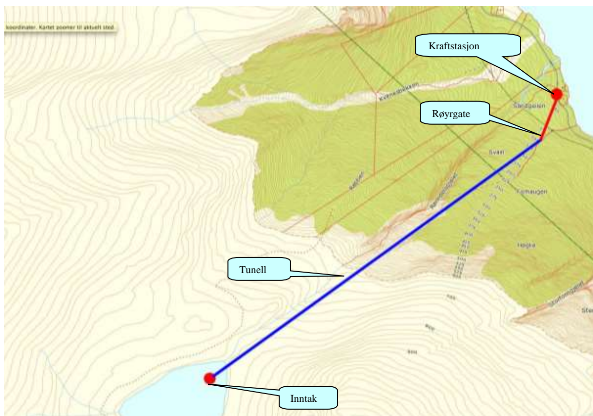
Figur 3. Kartutsnittet viser i grove trekk dei viktigaste naturinngrepa i form av inntak, tunell, røyrgate og kraftstasjon.
