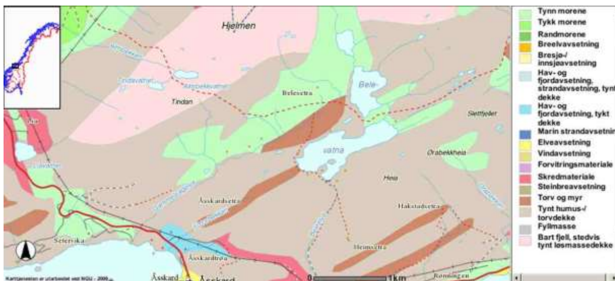
Figur 10. Tiltaksområdet har relativt lite løsmasser i det meste av området. Mesteparten er berg med et tynt torv- eller humusdekke. (Kilde NGU).
