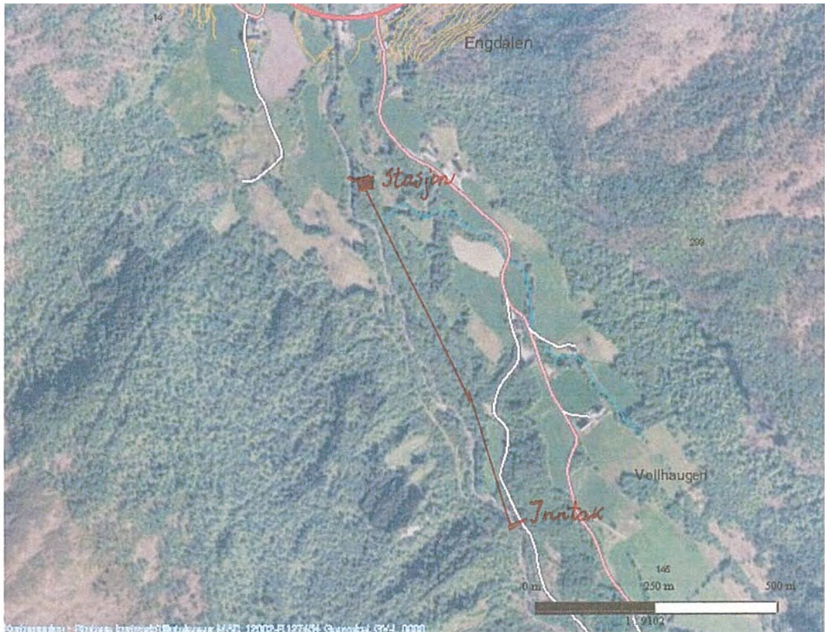
Figur 2. Dette flyfotoet er henta frå Gislink si kartteneste og viser utbyggingsområdet med inntak, røyrgate og stasjon. Heilt øvst i biletet kan ein sjå litt av E 39 der han passerer Engdalen nær sjøen. (Foto FGO ©).
