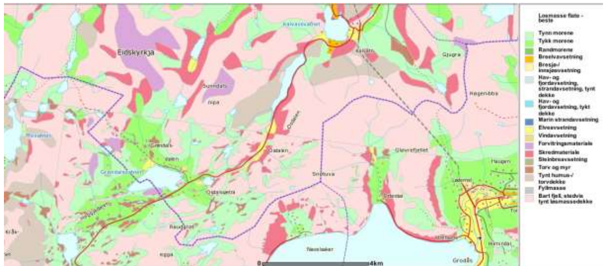
Figur 7. Som lausmassekartet viser, så er det ganske tynne morenelag innan det meste av utbyggingsområdet. Men i vestenden av Osdalssætrevatnet er det litt elveavsetning. På austkanten av vatnet er det noko rasmaterialar og nake fjell. (Kjelde NGU).
