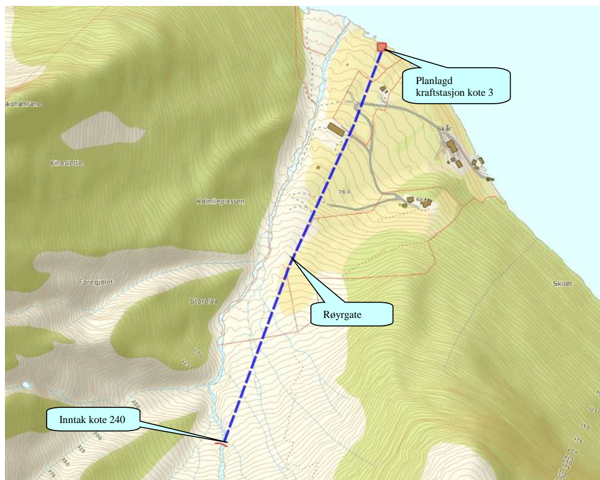
Figur 3. Kartutsnittet viser i grove trekk dei viktigaste naturinngrepa for utbyggingsplanane, i form av inntak, røyrgate (blå) og kraftstasjon. For fleire detaljar, sjå konsesjonssøknaden.
