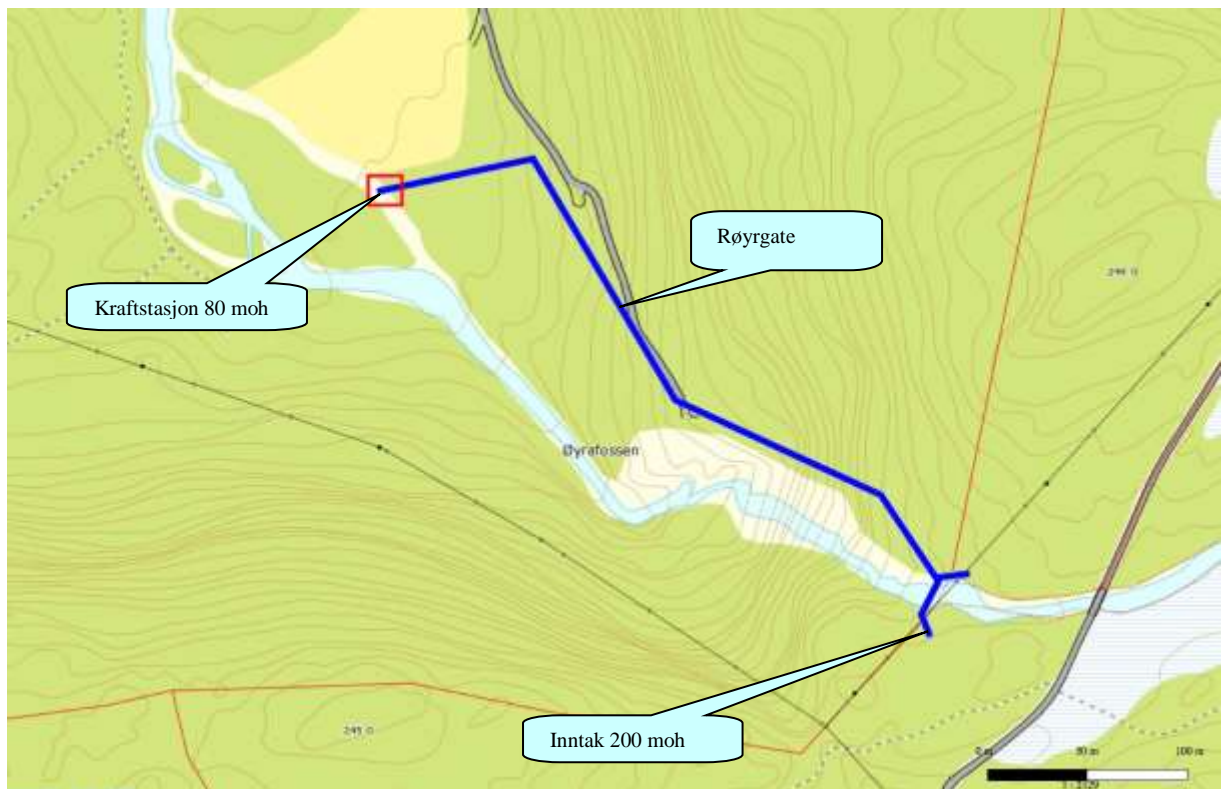
Figur 3. Kartutsnittet viser i grove trekk dei viktigaste naturinngrepa i form av inntak, røyrgate og kraftstasjon.
