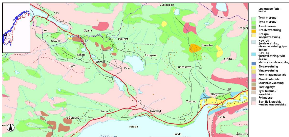
Figur 9. Om ein skal tru dette lausmassekartet så er det mest bart fjell med tynt lausmassedecke innan utbyggingsområdet. Berre heilt øvst ved Svingesetvatnet er noko tynne morenemassar. (Kjelde NGU).
