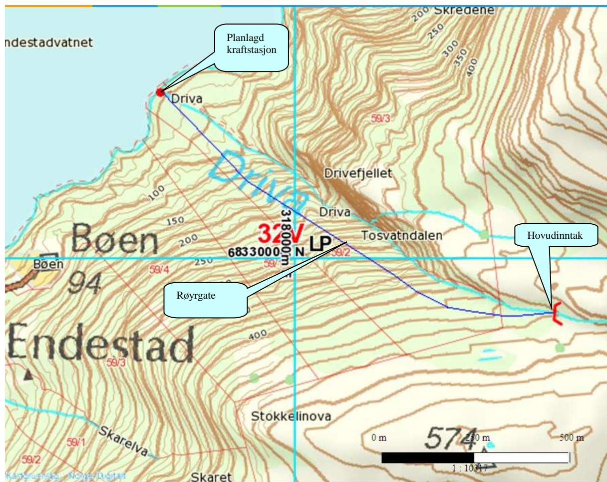
Figur 4. Kartutsnittet viser i grove trekk dei viktigaste naturinngrepa i form av inntak, røyrgate og kraftstasjon.
