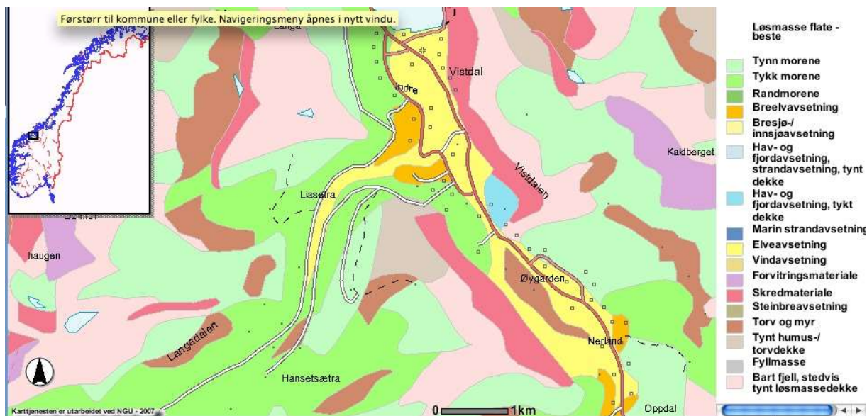
Figur 6. Ved inntaket og langs heile elvestrengen er det elveavsetningar. Også røyrtaséen vil for det meste gå i elveavsetningar. (Kjelde NGU)
